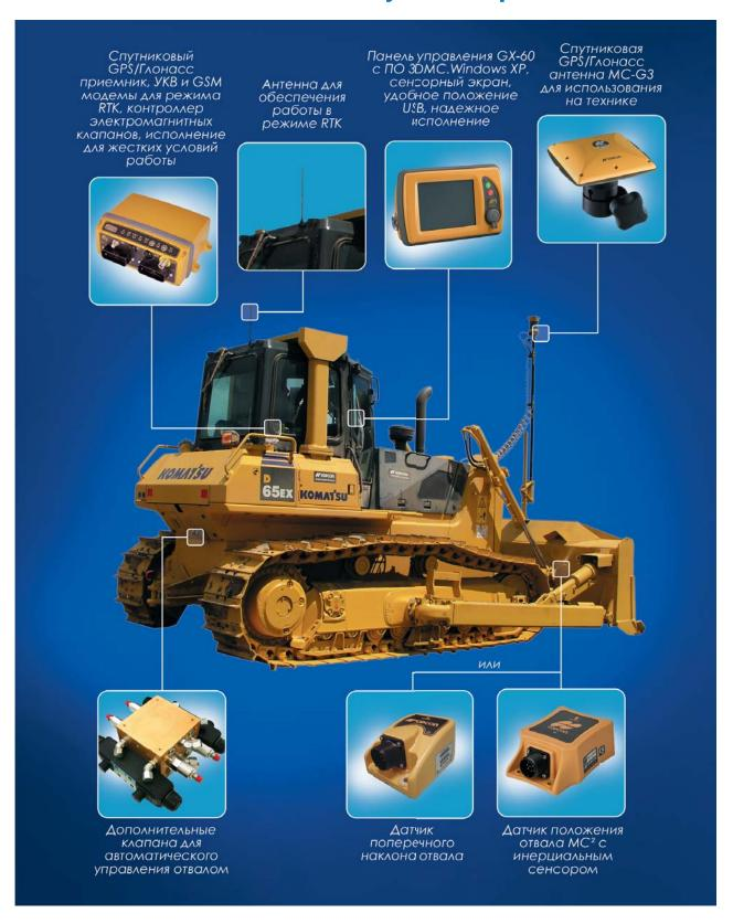
Для работы спутниковой системы нивелирования Topcon 3D ГНСС требуется наличие спутниковой базовой станции. Получите подробную информацию у вашего местного дилера Topcon.
